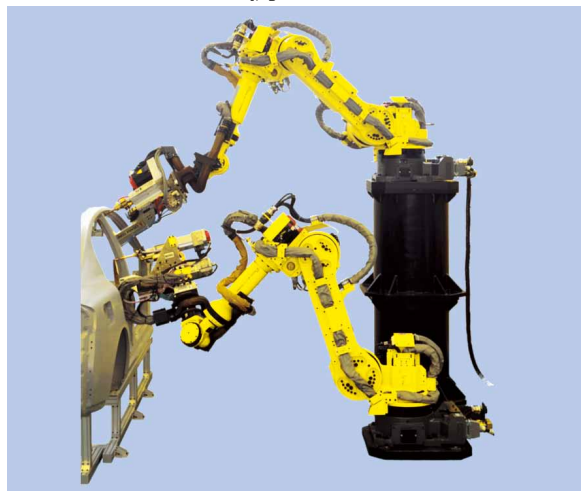
R-1000iA/80Fによる高速スポット溶接
